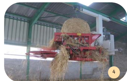
Pailleuse en service.
